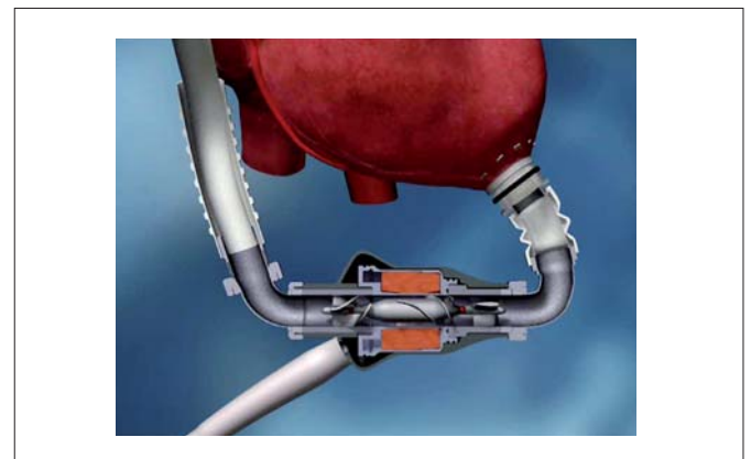
Obr. 4: Průřez axiální nepulsatilní MSP HeartMate II napojenou přes brot levé komory.
